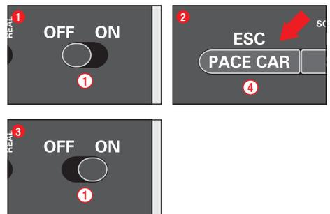
Zur Wiederherstellung der Werkseinstellungen verfügt die Control Unit über eine Reset Funktion.
