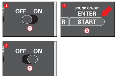
Der Bestätigungston beim Überfahren der Sensoren und der Tastenbedienung kann abgeschaltet werden. Halten Sie hierfür die „START/ENTER“ Taste (3) bei ausgeschalteter Control Unit gedrückt, schalten Sie die Bahn ein und lassen die „START/ENTER“ Taste (3) wieder los. Der Quittierungston beim Einschalten der Control Unit kann jedoch nicht ausgeschaltet werden.
