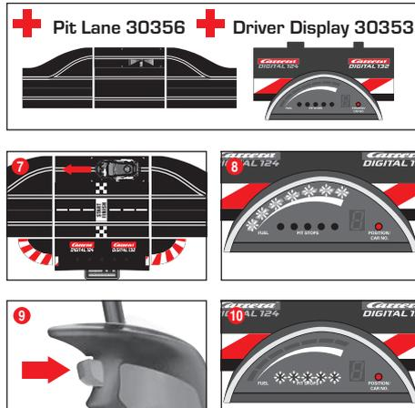
Der aktuelle Tankinhalt des Fahrzeuges kann über die Balkenanzeige mit 5 grünen und 2 roten LEDs des Driver Displays abgelesen werden. Zum Auftanken mit dem Fahrzeug in die Pit Lane über den Tanksensor fahren Abb. 7. Die Balkenanzeige beginnt nun zu blinken, Abb. 8, und das Fahrzeug kann über das Festhalten der Weichtaste aufgetankt werden Abb. 9. Die Anzahl der Tankvorgänge wird durch Blinken bzw. Leuchten der gelben LEDs angezeigt, Abb. 10 (siehe auch Driver Display).
