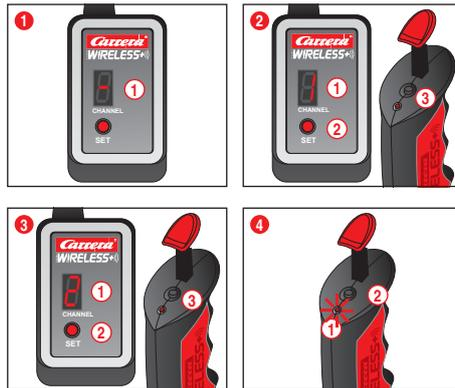
Damit die Handregler zur Steuerung der Fahrzeuge genutzt werden können, müssen Sie einmal an den Receiver „gebunden“ werden. Schalten Sie dazu die Bahn ein.
