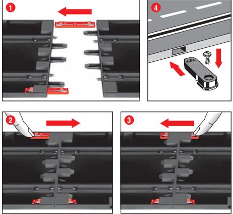
**1 + 2 + 3** Vor dem Aufbau Verbindungsclips wie in Abb. 1 beschrieben in die Schiene stecken. Schienen auf einer ebenen Unterlage zusammenstecken. Verbindungsclips gem. Abb. 2 bis zum hörbaren Einrasten in Pfeilrichtung bewegen. Verbindungsclip kann auch nachträglich eingesteckt werden. Das Lösen der Verbindungsclips ist in beide Richtungen durch einfaches Herunterdrücken der Klemmnase möglich (siehe Abb. 3)
